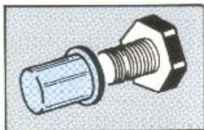
ガレージ、物置などのボルトの出っ張りに、また組立て式のベッド、本棚等の止めネジの保護にも利用できます。
