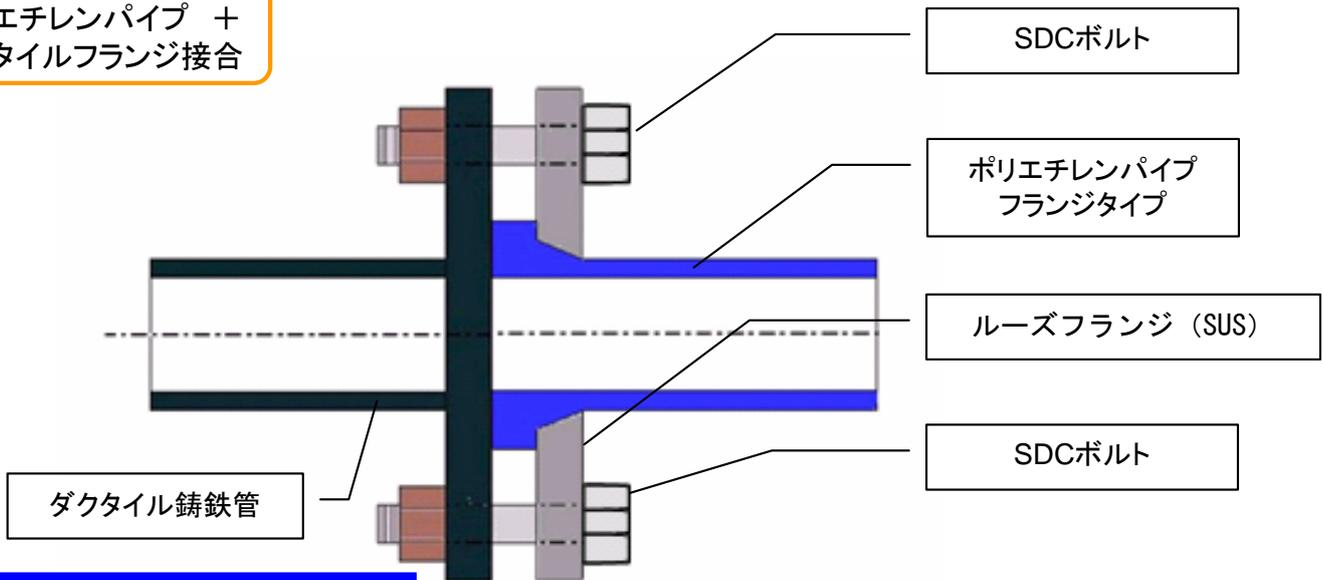
水道配水用ポリエチレン管および管継手
