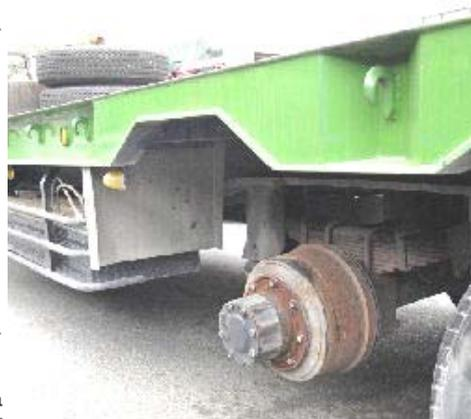
走行中にタイヤが外れたトレーラー。ボルト全てが折れている。
